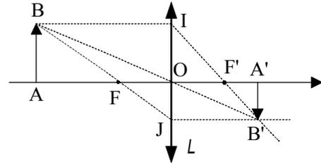
8. On a, par définition,  $G_t = \frac{\overline{A'B'}}{\overline{AB}}$ . Or, on a vu que  $\frac{\overline{A'B'}}{\overline{AB}} = -\frac{\overline{OF}}{\overline{FA}}$  et comme par ailleurs  $\overline{OF} = f = -f'$ , il vient :
